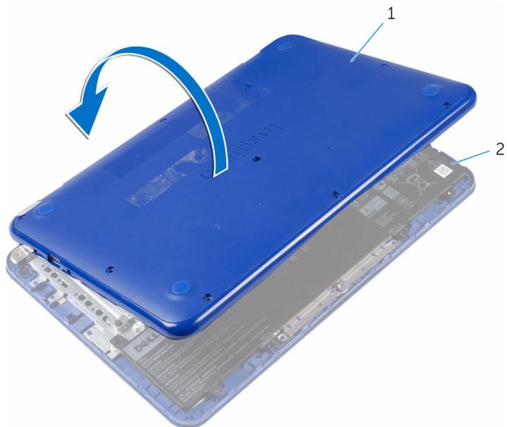
1 sklop poklopca kućišta
