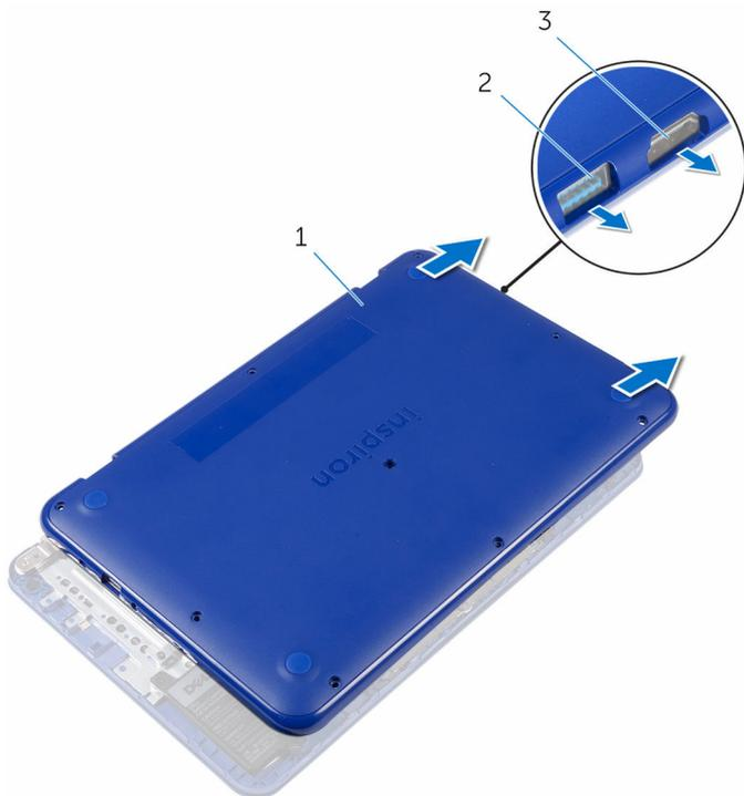
1 sklop poklopca kućišta
