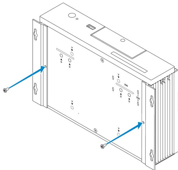
3. 在墙壁上钻四个与安装托架上的孔相对应的孔。
