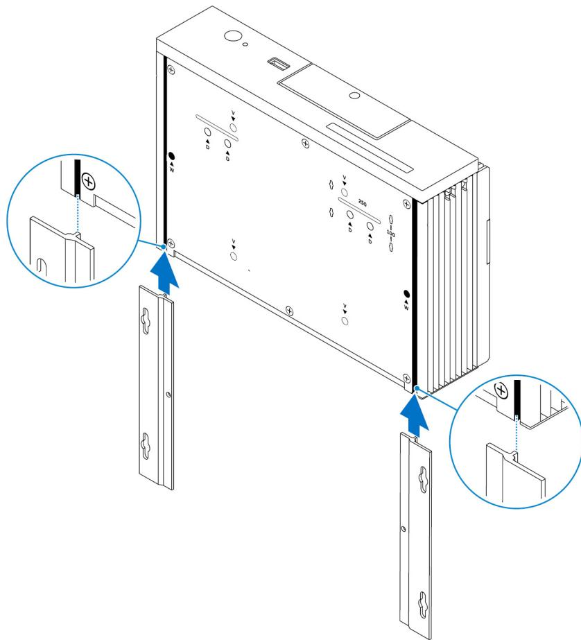
2. 通过使用两个 M3x5 螺钉，将两个安装托架固定至 Embedded Box PC 的背面。
