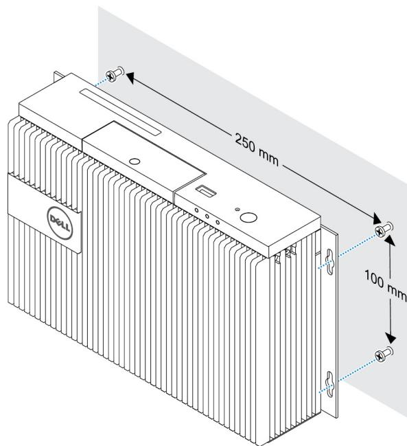
5. 将 Embedded Box PC 固定至墙壁。
