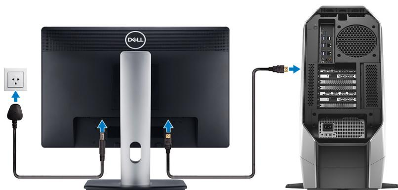
**i** 注：您的计算机背面板上会包含 DisplayPort。将显示器连接到计算机的独立显卡。
