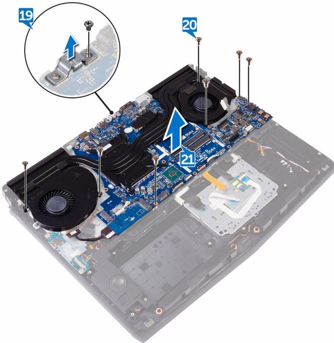
**22** Entfernen Sie die [Kühlkörperbaugruppe](#).
