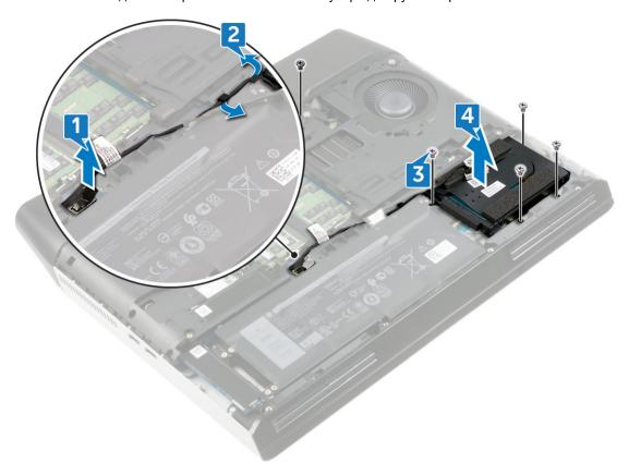
5 Отсоедините от жесткого диска в сборе соединительную планку.
