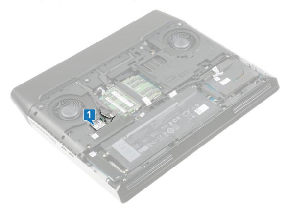
2 Выверните винт (M2x3), с помощью которого кронштейн платы беспроводной связи крепится к системной плате.
