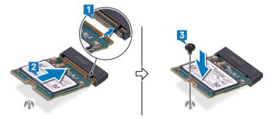
**4** Совместите винтовые отверстия на охлаждающей пластине M.2 с резьбовыми отверстиями на упоре для рук в сборе и системной плате.
