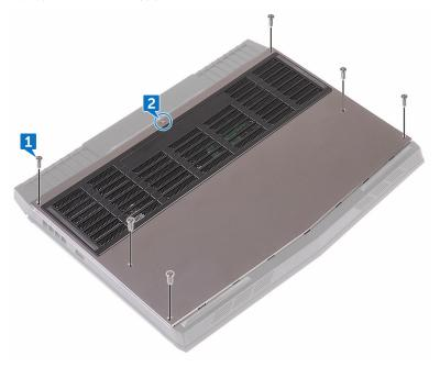
使用塑料划片,轻轻地撬起,从计算机基座上的插槽中释放基座盖上的卡 3 舌。
